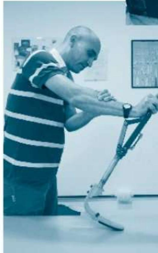
El diseño tiene un resorte para la restitución, luego de la flexión de la rodilla, y un cilindro neumático como amortiguador con control de caudal para permitir el control de giro.
